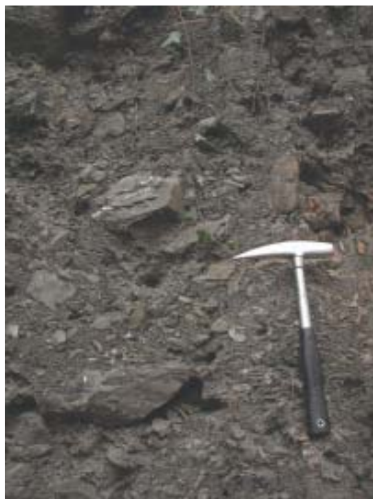
Foto 4.4.3 - Crocetta d'Orero (Comune Serra Riccò - GE) - Argilliti di Montoggio. Dettaglio del materiale coinvolto in un fenomeno di colamento; si osservi la tessitura matrice-sostenuta, la forte componente argillosa della matrice stessa e la presenza di clasti angolosi di natura calcareo-marnosa. L'origine di questi frammenti è da ricercare nella falda detritica derivante dallo sfacelo delle soprastanti balze costituite dai Flysch del M. Antola.
