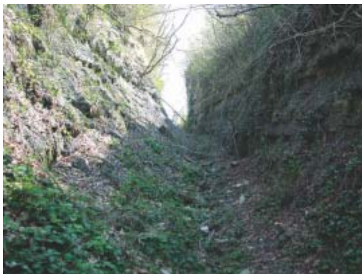
Foto 4.3.4 - Loc. Rocchetta (Comune di Cengio - SV) - Formazione di Rocchetta (BTP). Particolare trincea della frana planare relitta, da notare la struttura della sequenza sedimentaria.
